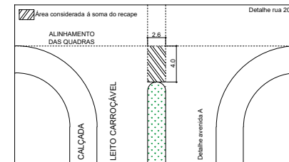
05. DETALHE DA EXTREMIDADE DO CANTEIRO ESC: 1/50
