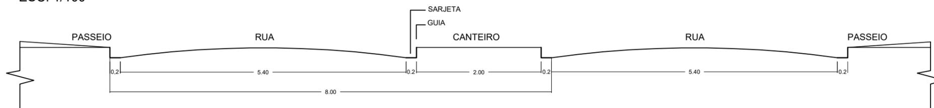
03. DETALHE DA PAVIMENTAÇÃO ASFÁLTICA
