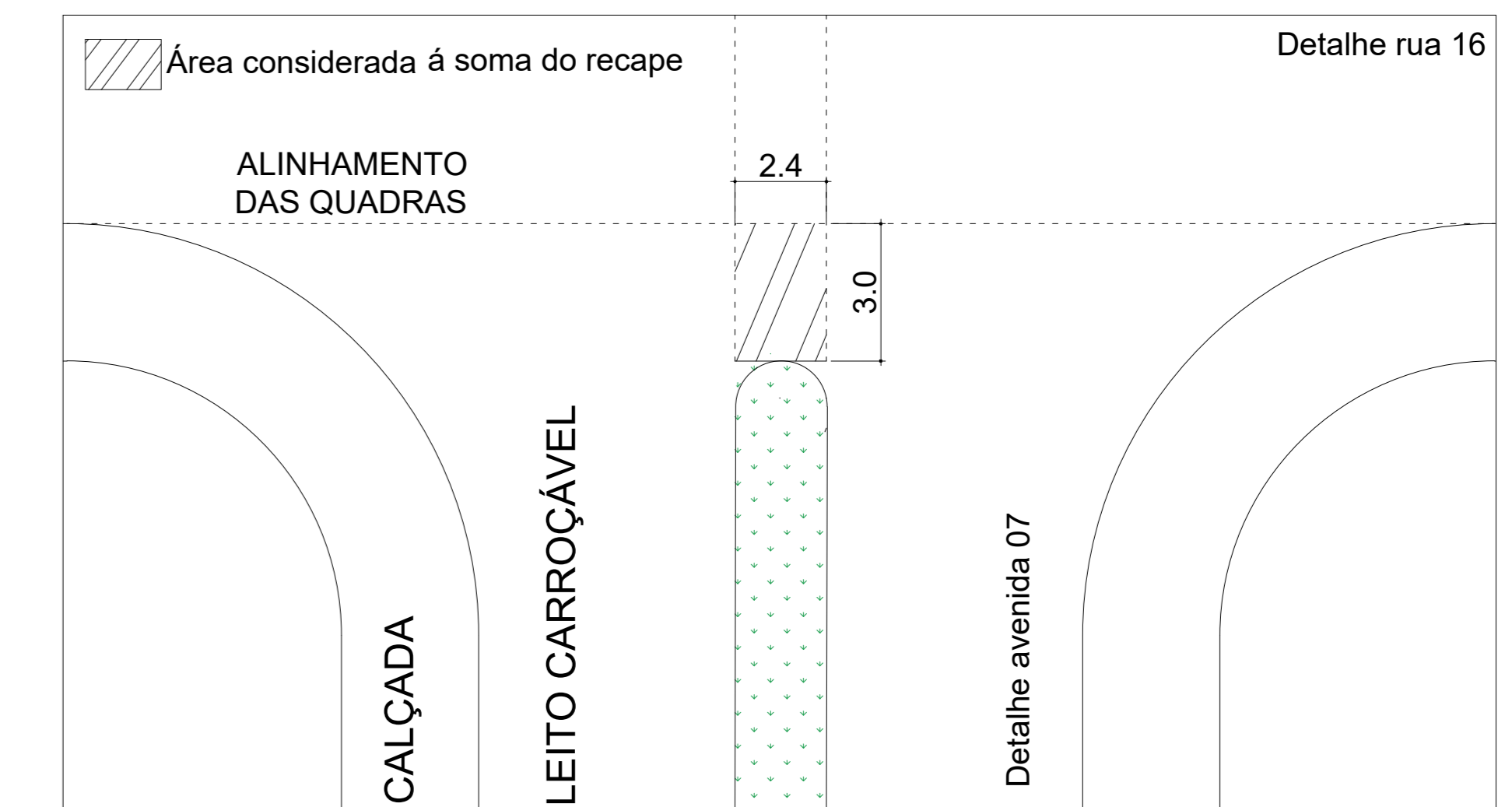
05. DETALHE DA EXTREMIDADE DO CANTEIRO ESC: 1/50
