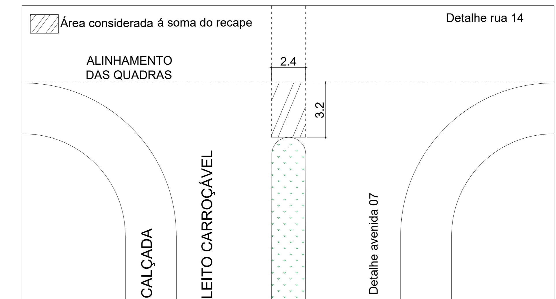
07. DETALHE DA EXTREMIDADE DO CANTEIRO ESC: 1/50
