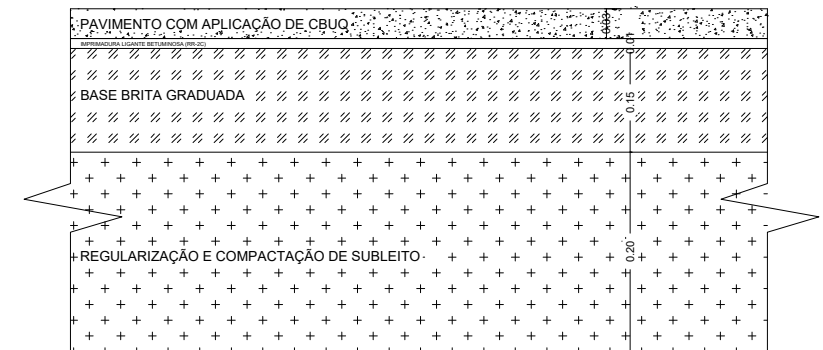
03. DETALHE DA PAVIMENTAÇÃO ASFÁLTICA ESCALA ILUSTRATIVA
